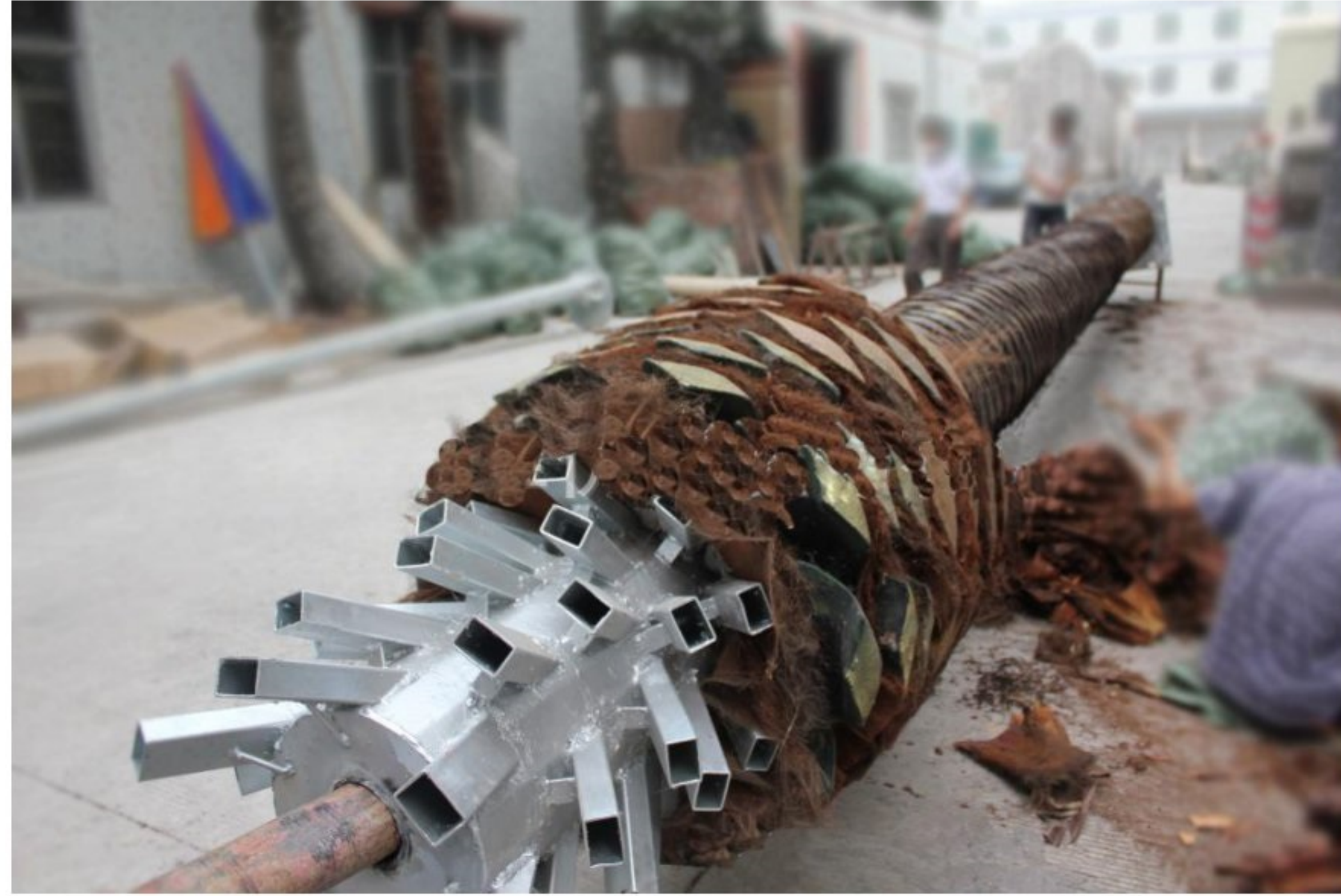
内部结构 Interior structure
